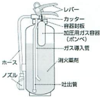
加圧式消火器の内部構造
